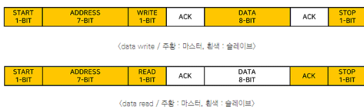
그림 2. I2C 통신 프레임 포맷 Fig. 2. I2C communication frame format
